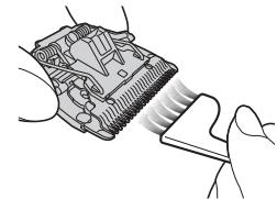
3. Bürsten Sie die Haare zwischen der festen Klinge und der beweglichen Klinge weg, indem Sie den Reinigungshebel (a) für die Reinigung nach unten drücken, um die bewegliche Klinge anzuheben.
